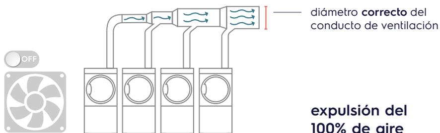
Si el conducto de ventilación tiene un diámetro constante:
